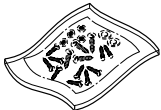
Sac de pièces (Comprend 4 vis à tête plate #10-2", 8 vis #8-3/4", 4 écrous #10-32, 2 ancrages de gypse et 2 rondelles 3/16" DI x 3/4" DE)
